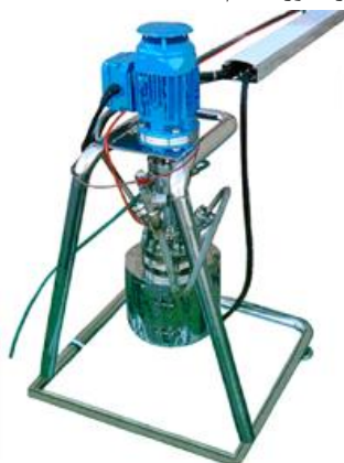
شکل (۲): نمای بیرونی راکتور مورد استفاده با متعلقات
